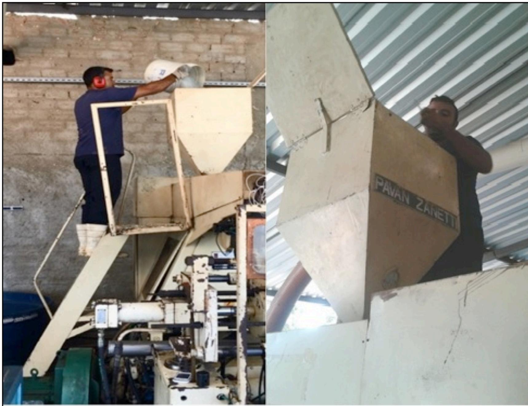
a) risco de acidente: desnível de altura • b) funil de alimentação na parte superior
