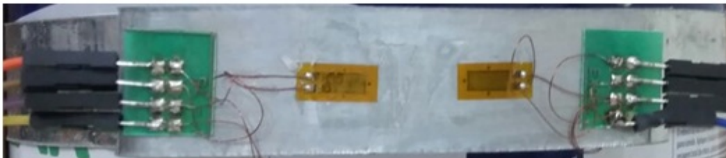
Figura 5. Sensores instalados na parte frontal da cinta
